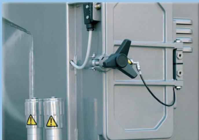
Il nuovo circuito di asciugamento equipaggiato con ventilatore ad alta portata ed alta prevalenza e' in grado di garantire un buon grado di asciugatura. Per una protezione ottimale degli scambiatori dell'impianto frigorifero tutti i modelli della Serie **NOVA** sono dotati di un **DOPPIO FILTRO ARIA**, facilmente ispezionabili, ad accesso facilitato, attraverso un comodo portello.
