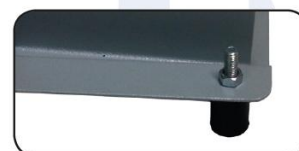
POMPA A VUOTO SU CULLA ANTIVIBRAZIONE ANTI-VIBRATION SUPORT ON VACUUM PUMP
